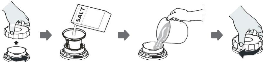
1. Entfernen Sie den unteren Korb und schrauben Sie den Behälterdeckel ab.
