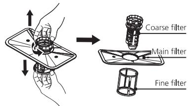
2 El filtro fino se puede sacar de la parte inferior del conjunto del filtro. El filtro grueso se puede separar del filtro principal apretando suavemente las pestañas en la parte superior y tirando de él.
