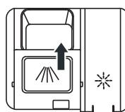
3 Feche a aba deslizando-a para a frente e depois pressionando-a para baixo.
