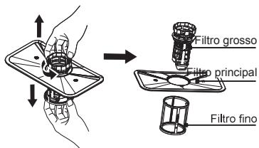
1 Segure o filtro grosso e gire-o no sentido anti-horário para desbloquear o filtro. Levante o filtro para cima e para fora da máquina de lavar louça.
