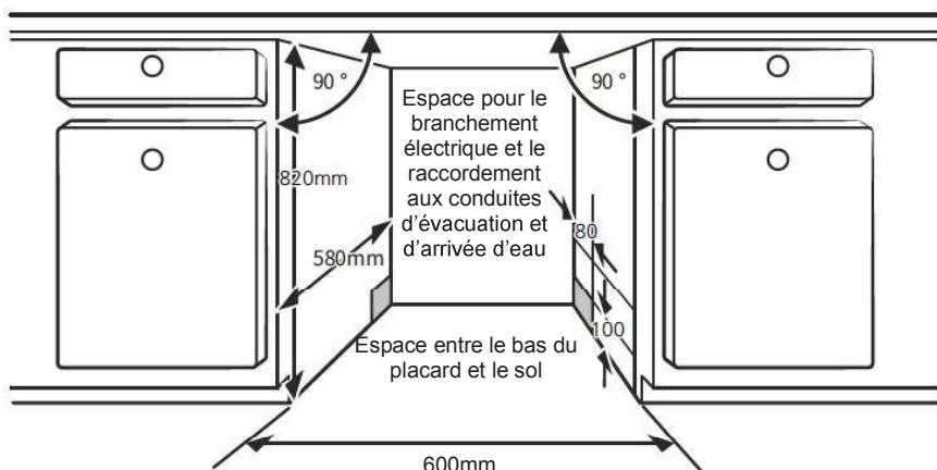
2. Si le lave-vaisselle est installé près d'un angle, prévoyez une distance de sécurité pour l'ouverture de la porte.
