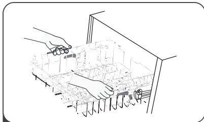
1 Para levantar a cesta superior, apenas levante a cesta superior no centro de cada lado até que a cesta se encaixe na posição superior. Não é necessário levantar o cabo do ajustador.
