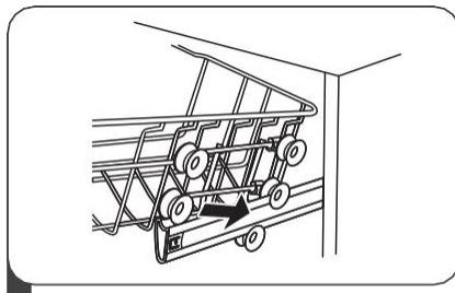
3 Befestigen Sie den oberen Korb wieder an den oberen oder unteren Rollen.
