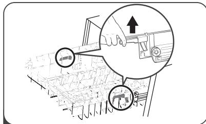
2 Para abaixar a cesta superior, levante cabos de ajuste de cada lado para libertar a cesta e abaixe-a para a posição inferior.
